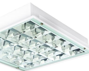
Las luminarias doble louver parabólico empotrables para tubos T8 se utilizan en locales donde es importante el control del haz lumínico, la óptica doble parabólica evita el deslumbramiento y genera un excelente confort visual.
